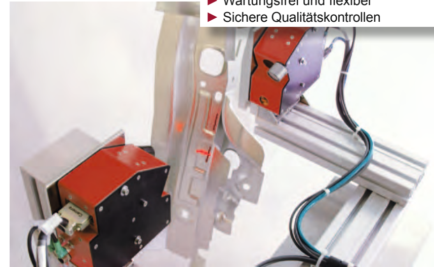
Schweißnaht-Geometrieprüfung von automobilen Komponenten (Quelle: EHR®)
