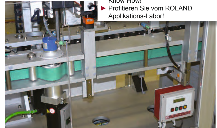
Pharma Blister Inhaltskontrolle (Quelle: IWK)
